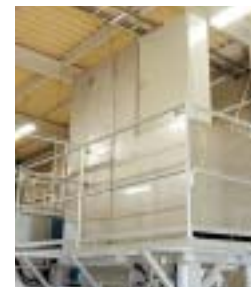
「スクラパーブース(水膜板付きスクラパーB型)」。豊富なウォーターカーテン水によって、塗料ミストを水面に打ち落とします。カーテン正面の塗料付着汚れがなく、清潔に保つことができます。
