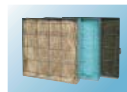
塗装ブース排気用の「アレスターセット」。焼付塗装を施した1.6mm鉄製特殊枠の中にフィルターを入れ、格子で両面から押さえて使用します。枠をボリでつなげることで簡単に組み立てられ、ご使用になる塗料に応じて4種類のフィルターを選択できます。
